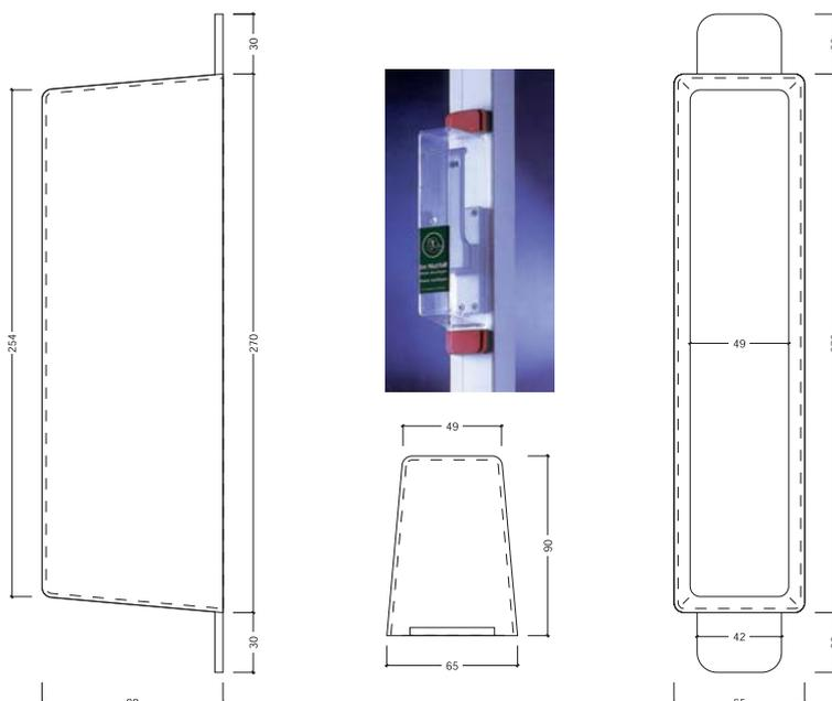
Die **Fluchttürhaube vom Typ E** besteht aus einem festen Acryl-Kunststoff, der nicht mehr zerplatzt, so dass sie wieder verwendet werden kann. Im Gefahrenfall schlagen Sie die Haube ab, wodurch der Spezialverschluß mit rot-grün-Kennzeichnung abfällt und der Türgriff frei ist. Ein Piktogramm auf der Haube gibt den Benutzungshinweis. Die **Haube E** eignet sich zum Sichern von Treibriegeln **bei Türen mit schmalen Rahmen**.
